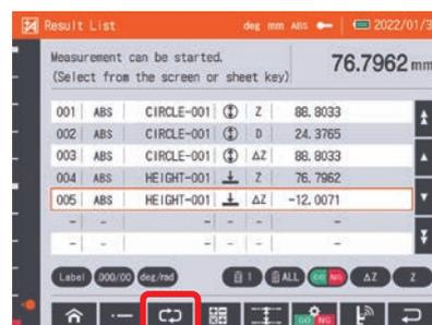
可使用脚踏开关(选件)或屏幕上的按钮重复执行上一次的测量。无需多余的操作，即可提高测量效率。
