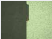
倍率低无法对细微的凸出形状宽度进行准确的测量
