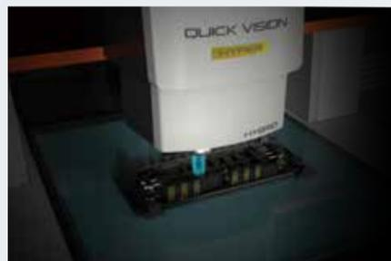
发动机控制单元的测量示例
