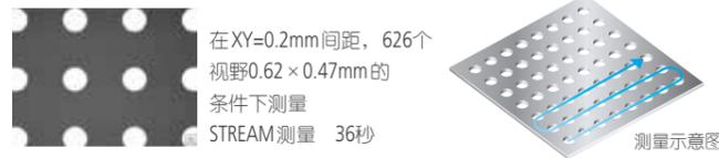
在XY=0.2mm间距，626个视野0.62×0.47mm的条件下测量
