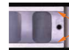
阶梯状工件的边缘测量(高分辨力模式)
